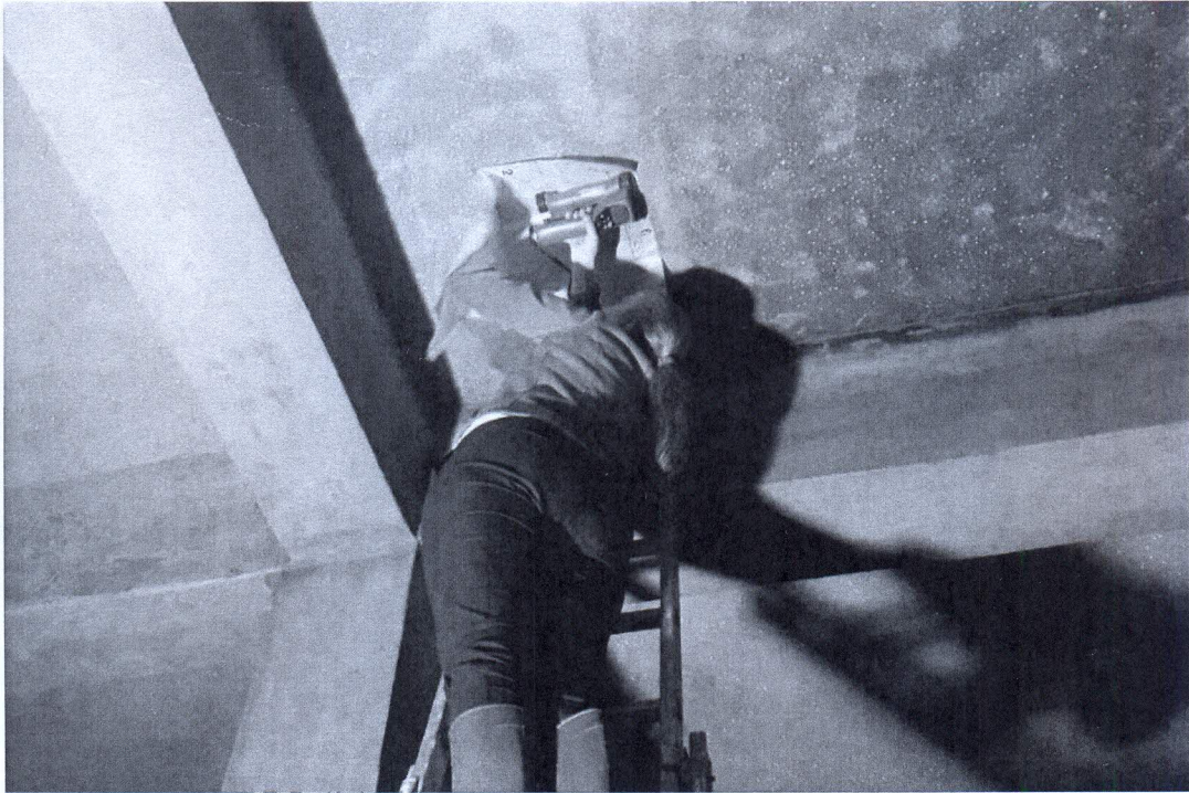
Φώτο 7: Μαγνητική σάρωση πλάκας οπλισμένου σκυροδέματος.
